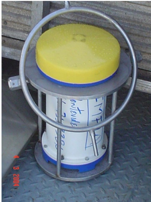
ADCP ubicado en su jaula para ser colocado en la piramide.
