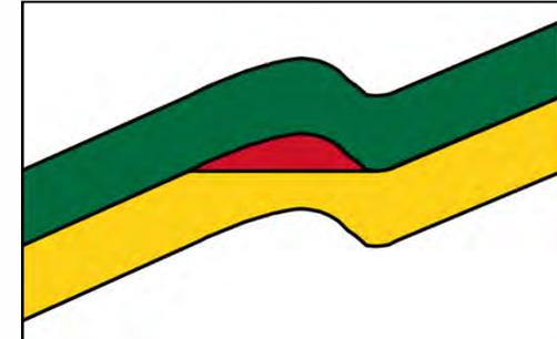
**2) Trampas estratigráficas:** formadas durante la depositación, como resultado de variaciones laterales y verticales en el espesor, textura, porosidad y litología de los estratos.
